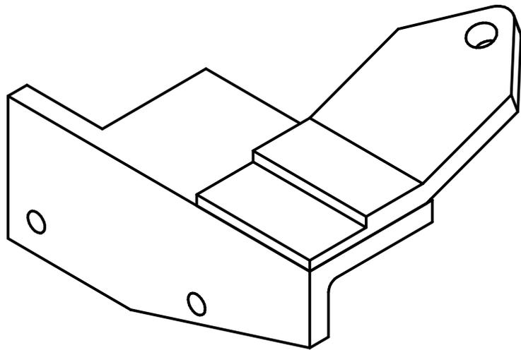
Winkel rechts und unten bünding anliegend, rundherrum verschweißen
